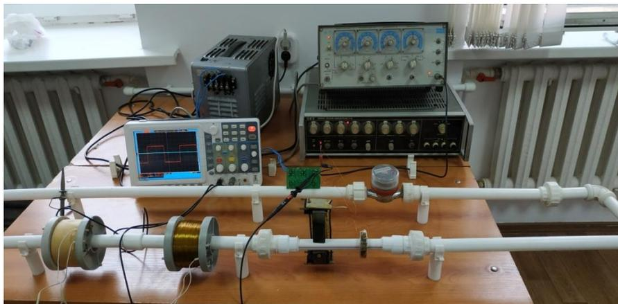
Рис. 2. Лабораторный стенд для исследования электромагнитной обработки воды
